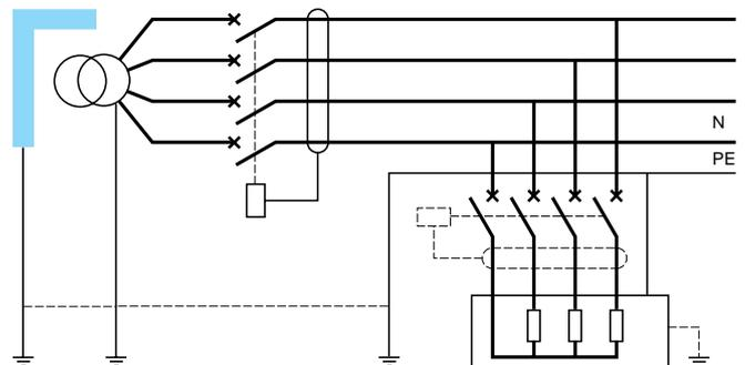
Le déclenchement est obligatoire au premier défaut. Un dispositif différentiel situé en tête de l'installation est nécessaire. L'emploi d'un dispositif de protection par départ permet d'améliorer la continuité de service.
