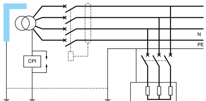
Le réseau est surveillé par un contrôleur permanent d'isolement (CPI). Au 1er défaut (non dangereux), signalisation par CPI. Au 2e défaut, déclenchement obligatoire (pour les magnétiques des disjoncteurs ou différentiels).
