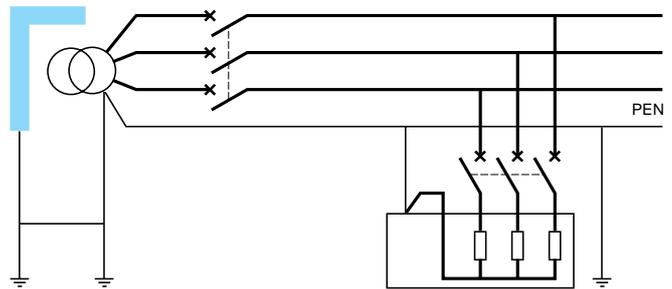
Le déclenchement est obligatoire au premier défaut. Un défaut phase-terre se traduit par un court-circuit. La protection est assurée par les déclencheurs magnétiques du disjoncteur.
