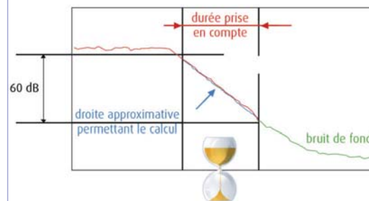
La réverbération se quantifie par le temps T_r que met un bruit émis pour diminuer de 60 dB lorsqu'il est interrompu.
