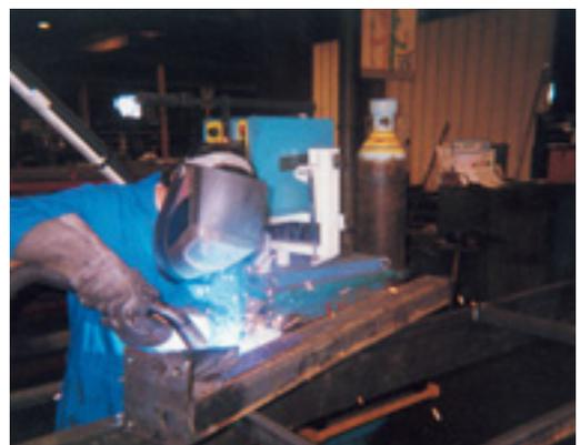
Photo 5.9. Système de torche de soudage avec aspiration intégrée.
