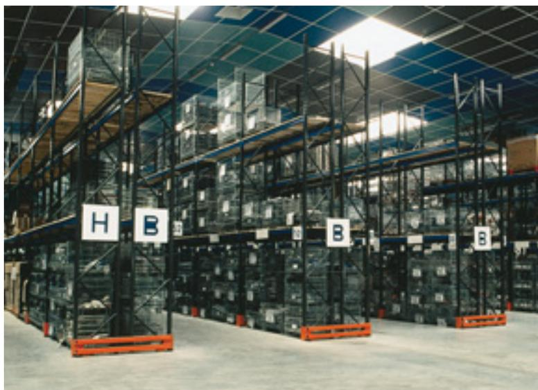
Photo 8.3. Exemple de racks aménagés sur le plan de la sécurité : plancher de positionnement et butées de pied d'échelle.
