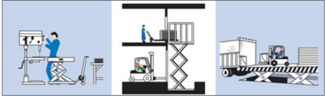
Figure 8.5. Exemples d'utilisation de tables élévatrices.
