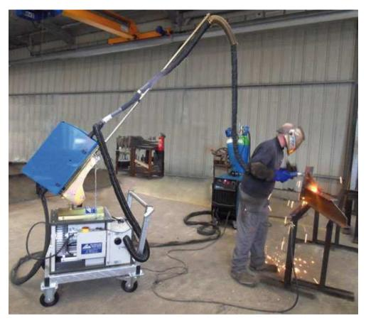
Exemple d'un poste de soudure MIG équipé d'une torche aspirante
