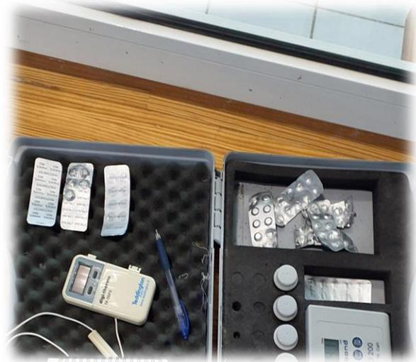
La société prestataire en charge des analyses relatives à la qualité de l'eau et de l'air utilise une valise dont les outils permettent de mesurer instantanément les taux de chlore, de PH et du chlore combiné de l'eau (chloramines).
