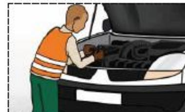
> Il est interdit d'intervenir sur un véhicule sans avoir préalablement débranché la batterie
