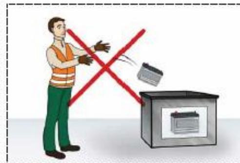
> Il est interdit de jeter brusquement une batterie : risque d'explosion
